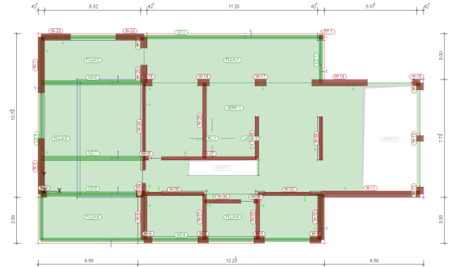
Bild 5. Modelliertes MicroFe-Modell der Decke über EG
