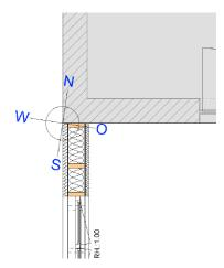
Bild 8. Bezugspunkt in einem ausgerichteten Modell
