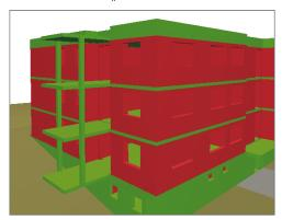
Bild 15. IFC Teilmodell "Rohbau" im BIMviewer
