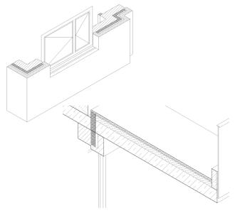
Bild 2. Mehrschalige Wand- Deckenkonstruktion
