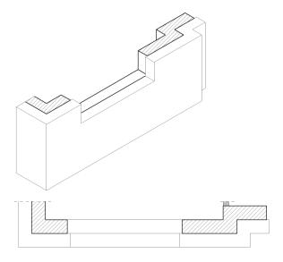
Bild 10. Darstellung Schraffur der tragenden Schichten
