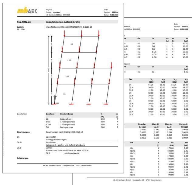
Bild 4. Beispielausgabe von Imperfektionskräften
