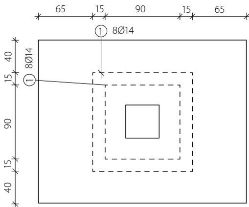
Bild 9. Draufsicht tangentiale Bügelanordnung
