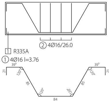
Bild 8. Schnitt Schrägstäbe
