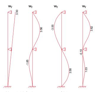
Bild 4. Beispiele für den Ansatz von Imperfektionen
