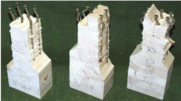
Bild 3. Versagensmechanismus: Ausknicken der Schrauben im Holz nach [5]
