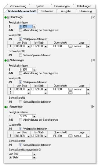
Bild 3. Eingabe Kapitel "Material/Querschnitt"
