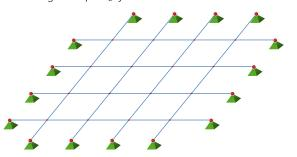
Bild 2a. Trägerrost ohne Randträger
