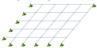
Bild 2b. Trägerrost mit Randträger oben und rechts
