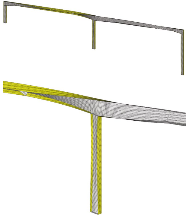
Bild 15. a) Biegedrillknickfigur eines zweifeldrigen Rahmens b) Ausschnitt der Knickfigur im Bereich der Mittelstütze
