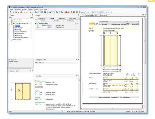
S073 berechnet und bemisst auf Schub beanspruchte Scheiben in Holz-Tafelbauweise auf der Grundlage der DIN 1052 (12/08).
