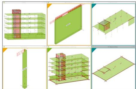
Denn für viele Tragwerke ist eine Nachweisführung am Gesamtsystem durch den erhöhten Modellierungsaufwand, z.B. bei einer realistischen Verbindung von Bauteilen, nicht von Vorteil. Aber auch für diesen Weg, der Berechnung am Gesamtsystem, ist der StrukturEditor vorbereitet und ein wichtiger Helfer.
