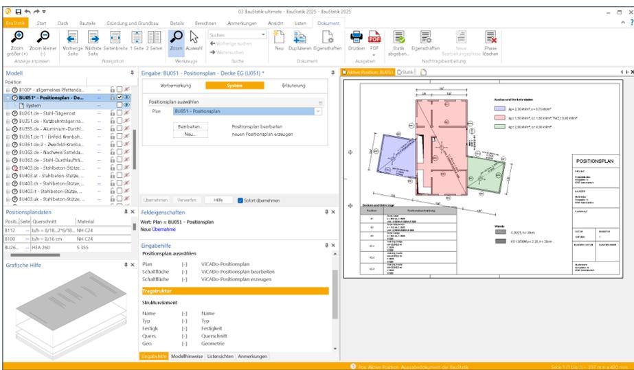
U051 ermöglicht ein schnelles Erzeugen und Einbinden von Positionenplänen in die Statik. Als Grundlage für den Plan können z.B. Teile der Architektenpläne eingefügt und um Maßketten, Positionsnummern und Querschnittsangaben erweitert werden.
