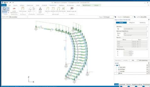
EuroSta dient der Berechnung und Bemessung von ebenen und räumlichen Stabtragwerken aus Holz oder Stahl. Es bietet eine effektive, grafische Bearbeitung der Tragstruktur durch die Integration von Eingabe, Statik, Nachweisen und Bemessung – einschließlich Systemknickstabilität, Eigenschwingungen und Numerik/Kinematik-Tests bis hin zur Anschlussbemessung.
