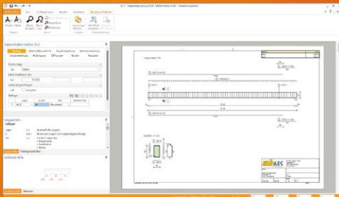
Mit VarKon-Modulen werden Schal- und Bewehrungspläne für Bauteile automatisiert erzeugt. Das Erzeugen der Pläne erfolgt allerdings nicht über eine grafische Konstruktion, sondern über die Eingabe der entsprechenden Parameter in einer speziell hierfür vorbereiteten Benutzeroberfläche. Dies ermöglicht eine schnelle Generierung von Bewehrungsplänen ohne lange Einarbeitungszeit.
