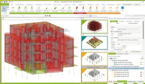
Der StrukturEditor verbindet auf eine beeindruckende Art und Weise die klassischen und etablierten Bearbeitungsmethoden der Tragwerksplanung mit der zukünftigen Arbeitsweise nach der BIM-Methode. Das komplette Tragwerk wird als Systemlinienmodell abgebildet. Dieses steht im Projekt als Grundlage für alle Nachweise, Lastermittlungen und Auswertungen zur Verfügung.
