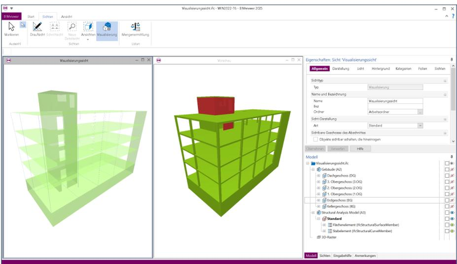
Das Modul BIMwork.ifc ermöglicht den bauteilorientierten Austausch von Gebäudemodellen im IFC-Format und somit die Zusammenarbeit von Architekturbüros und Fachplanern wie z.B. den Tragwerksplanern. Die Kommunikation im BCF-Format ist ebenfalls Teil des Leistungsumfangs.
