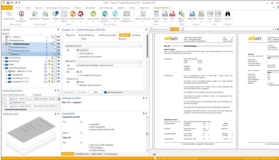
Das Modul „S007.de Vorbemerkungen“ ermöglicht die Zusammenstellung von unterschiedlichen Informationen und Informationsquellen zu einer umfassenden Vorbemerkung für das Statik-Dokument.
