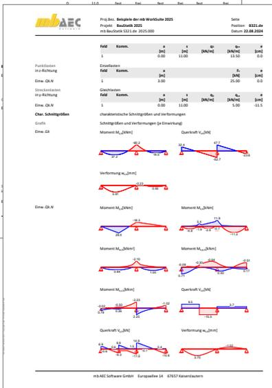
S322.de **Holz-Durchlaufträger, Doppelbiegung**
