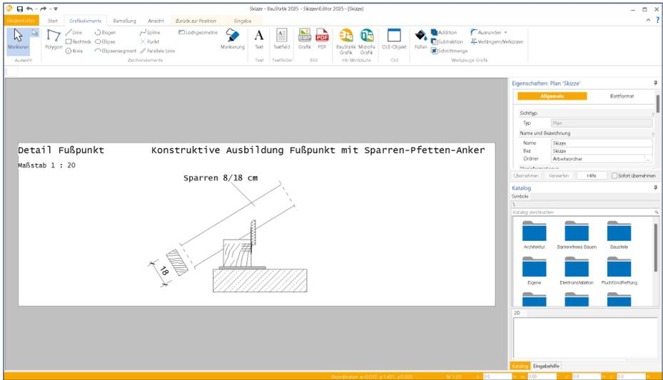
Der SkizzenEditor erlaubt ein schnelles Erstellen von Skizzen und deren Einbindung in die Statik. Als Grundlage für die Skizzen können Bilder, Ausschnitte aus eigenen Zeichnungen oder fremde dxf- oder dwg-Dateien verwendet werden.
