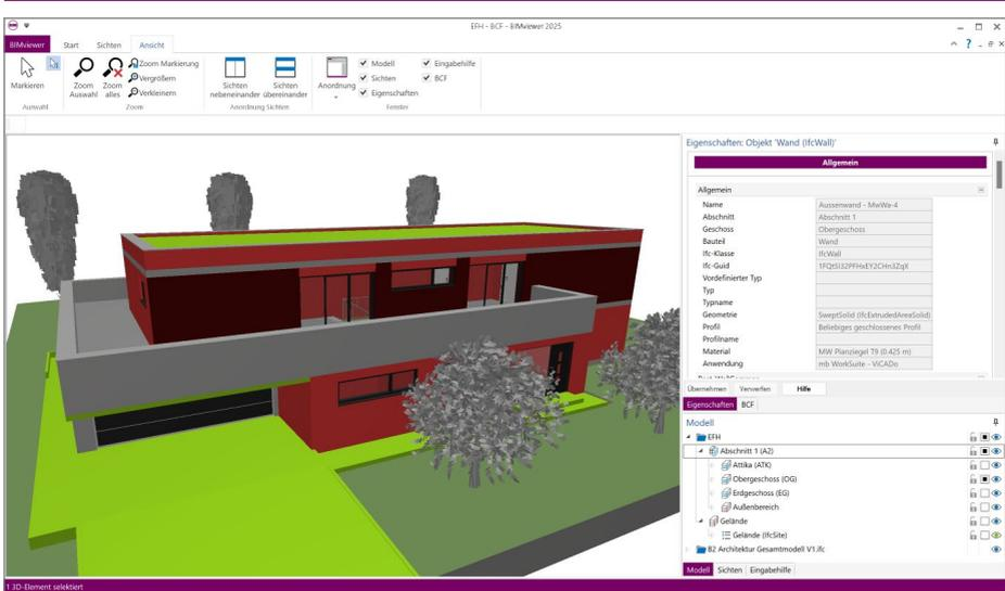
Der BIMviewer steht allen Anwendern der mb WorkSuite kostenlos zur Verfügung. Er kann zur Kontrolle von Architektur- sowie von Struktur-Analyse-Modellen eingesetzt werden.
